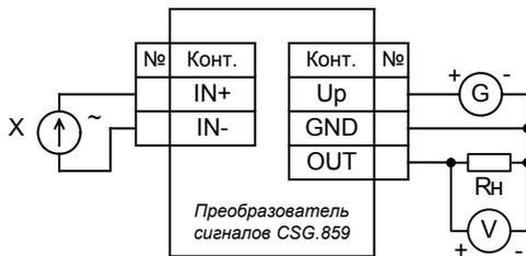
X - калибратор электрических сигналов, V - вольтметр универсальный, R<sub>н</sub> - образцовое сопротивление нагрузки 250 Ом, G - источник питания
