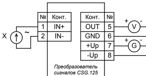
X - калибратор электрических сигналов,
